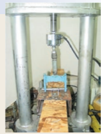
▲IC野地板用ビス引抜き強度試験
